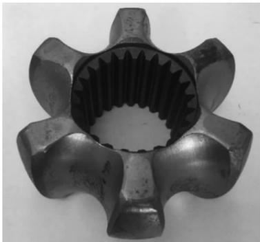
图 1 球笼联轴器内套
